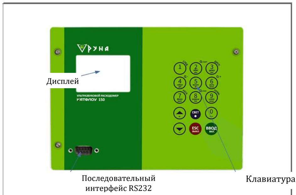
Рисунок 14: Схематичное изображение клавиатуры и дисплея
