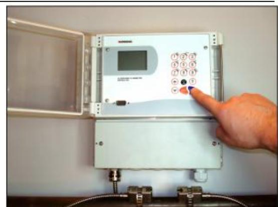
*KATflow 150 с креплением к стене с датчиками*
